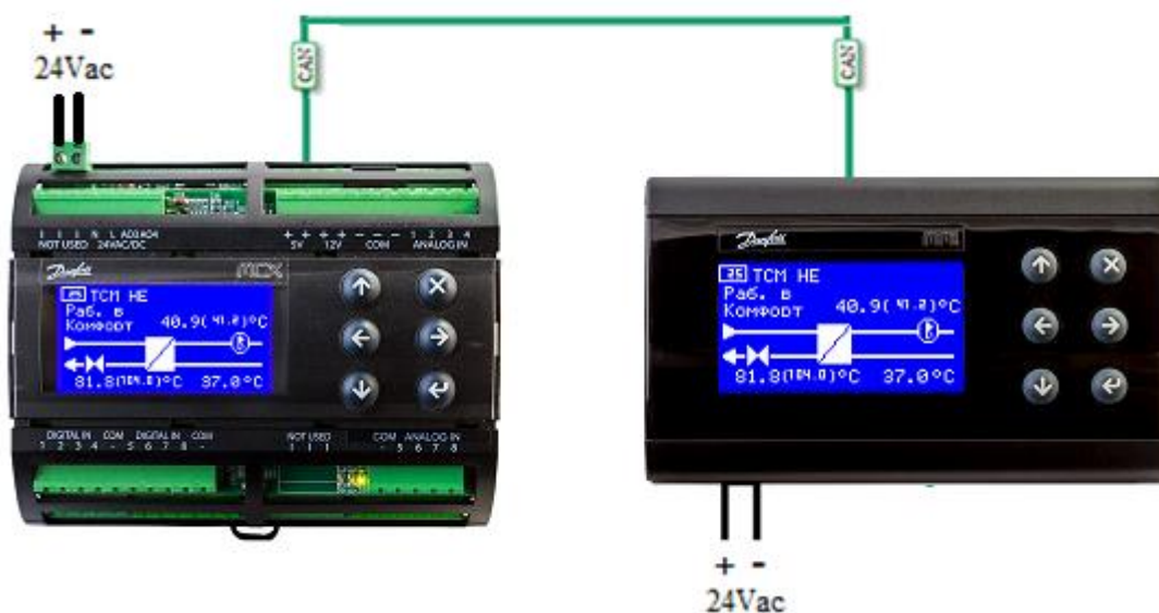
Рисунок 22. Подключение внешнего дисплея к одному модулю
