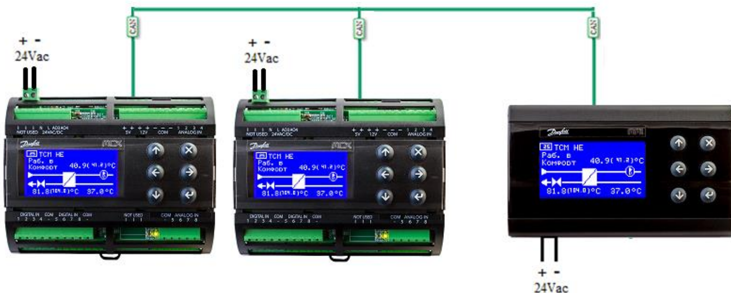
Рисунок 23. Подключение внешнего дисплея к двум модулям. В CAN-подключении среднего контроллера отсутствует перемычка между R120-CANH.
