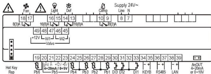
**6.3 ПОДКЛЮЧЕНИЕ И КОНФИГУРАЦИЯ КЛАПАНОВ**
