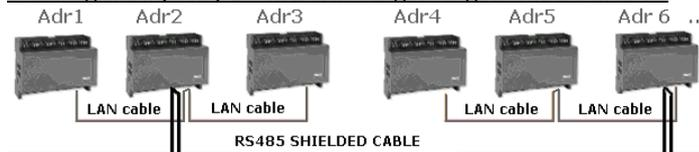
Параметр Aдр – это номер, идентифицирующий каждый прибор. Дублирование адресов не допускается. В этом случае не гарантируется синхронизация оттайки и связь с системой мониторинга (Aдр – это также адрес в сети ModBUS).
