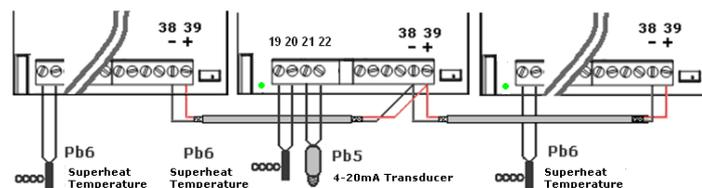
Требуется работающее соединение по сети LAN (на всех XM668D сети горит зеленый светодиод). Подключите и сконфигурируйте датчик давления только на **одном** XM668D в этой сети. Позднее, значение давления, считываемое с одного подключенного датчика, будет доступно для каждого контроллера, включенного в ту же локальную сеть LAN (См. п. 12.2).
